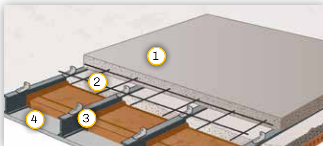
Podne ploče s šupljim blokovima i pokrovom od betona.
